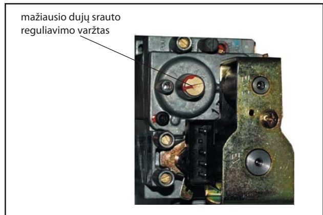
Pav. Universalus dujų vožtuvas „dujų armatūra“
